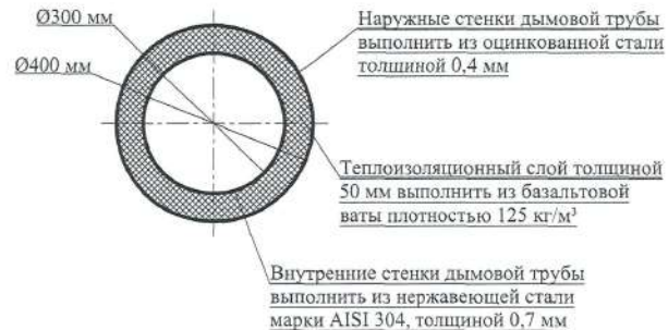
Сечение сэндвич трубы (вертикальный участок)
